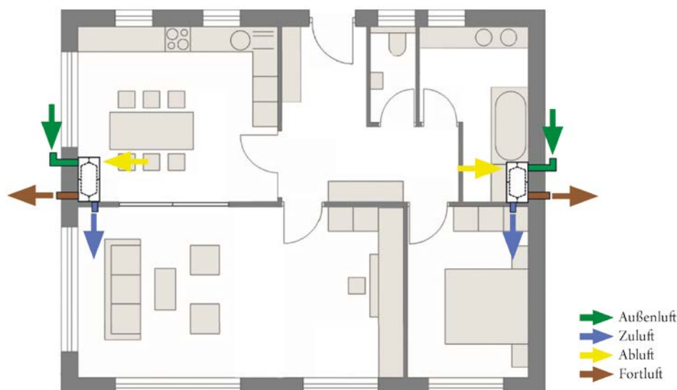
Abbildung 12: Gut geeigneter Grundriss für ein Raumverbundsystem – Zuluft in das Wohnzimmer und Abluft über Küche und Esszimmer bzw. Zuluft im Schlafzimmer und Abluft im Bad
