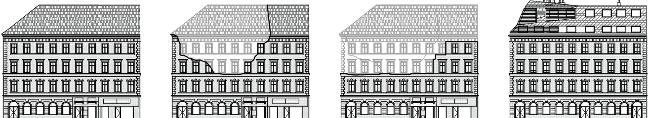
Ansicht Mariahilfer Straße: 1. Bestandsansicht – 2. Beschädigung durch Gasexplosion – 3. Baulinie Neuaufbau – 4. Ansicht nach Sanierung
